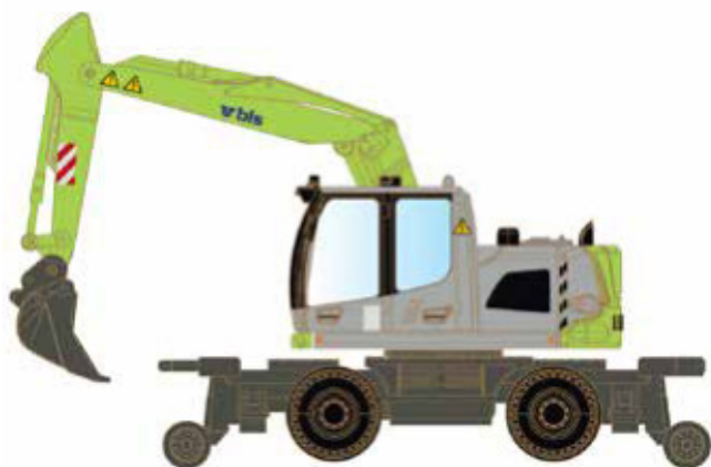
LC4269 ZWEIWEGE-BAGGER LIEBHERR A922 RAIL - BLS (CH)
