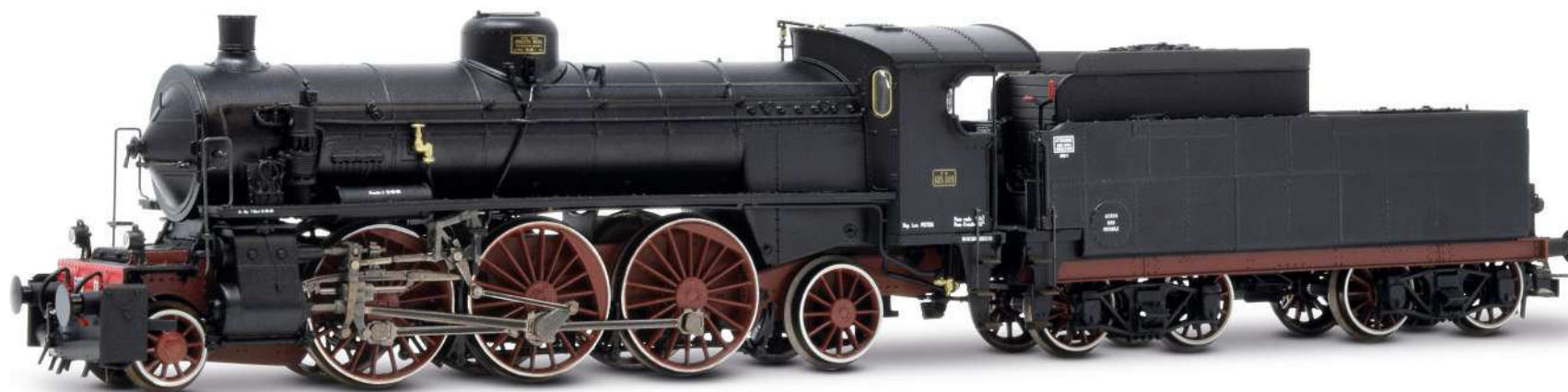
Tender con sopralzo carboniera e chiodature aggiuntive
