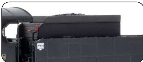
Tender con sopralzo carboniera e chiodature aggiuntive
