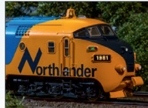
Classification Lights – sie werden auch als Begrenzungsleuchten bezeichnet und geben Auskunft über den Status des Zuges
